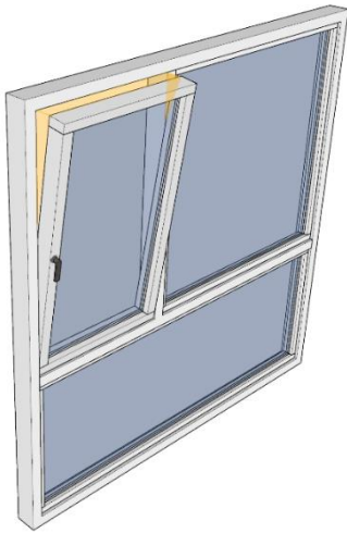
Figur 6-5: Åpningsareal for et bunnhengslet og/eller topphengslet vindu som er åpnet så mye systemet tillater.
