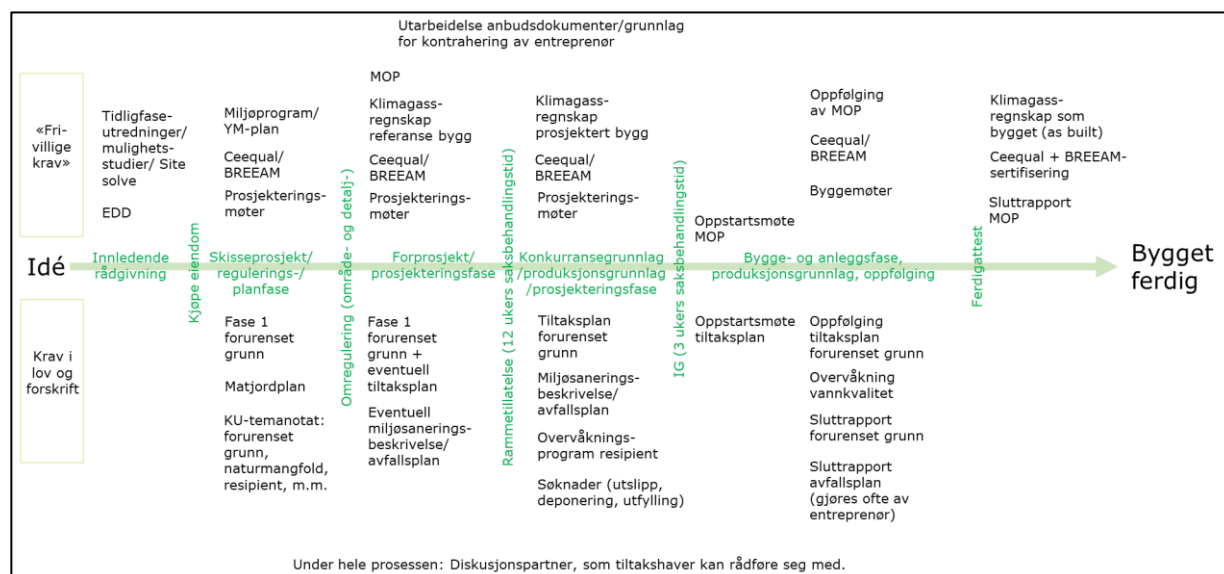
Figur 2. Illustrasjonen viser forholdet mellom lovpålagte og frivillige krav gjennom et prosjekteringsforløp (illustrasjon: Rambøll).
